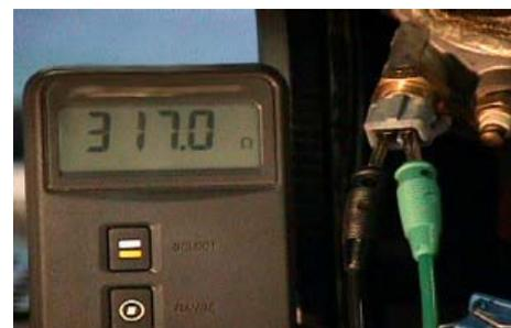
Medição da resistência com o motor quente
