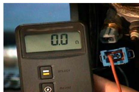
Resistência específica da ficha de sensor para a ficha do módulo de controlo
