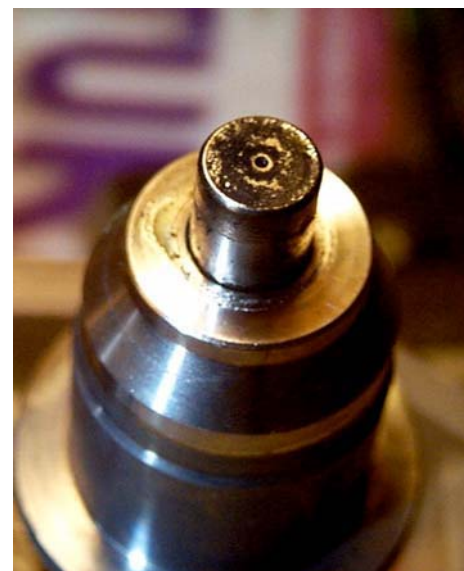
Injectores/ furo entupidos
