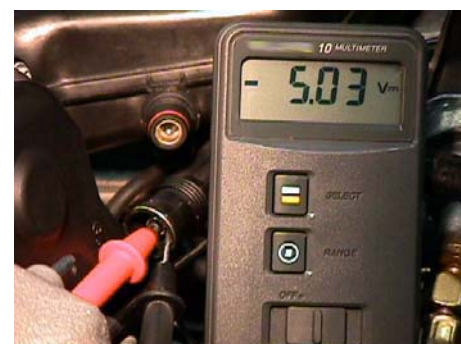
Alimentação de tensão no sensor
