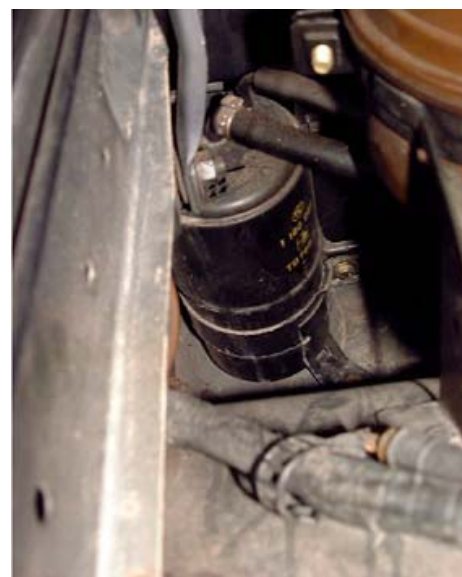
Reservatório de carbono activo
