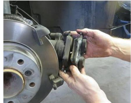
Prender a pinça do travão com um gancho adequado no amortecedor.
