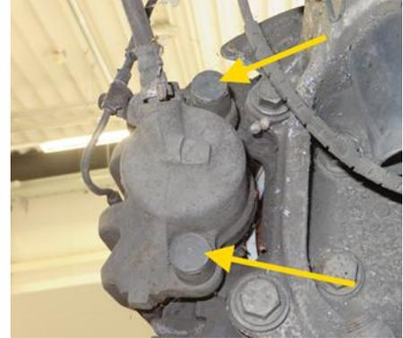
Desapertar e retirar os dois parafusos de fixação (pinos guia).
