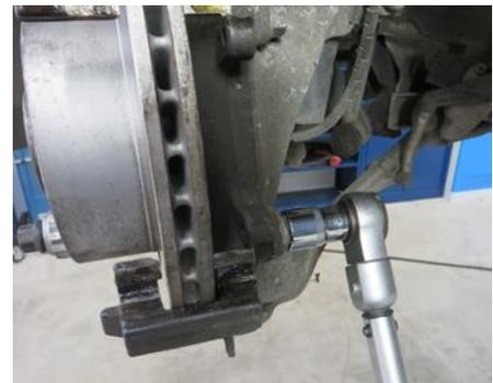
No final da limpeza das superfícies de encosto do suporte da pinça deve-se aplicar uma fina camada de pasta para travões que não contenha ingredientes metálicos e que não tenha características de condução elétrica.
