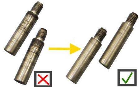
No final da limpeza deve-se aplicar uma fina camada de massa lubrificante nas superfícies de deslizamento dos parafusos guia. Nesta zona deve-se utilizar exclusivamente massa lubrificante à base de silicone.
