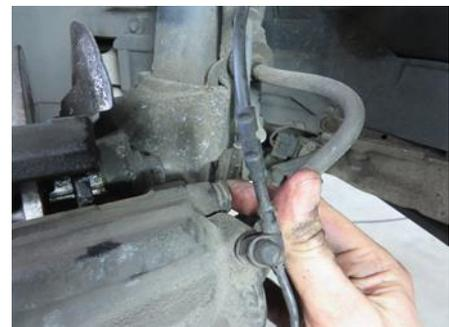
Voltar a fixar a cablagem e o tubo do líquido dos travões no suporte combinado.
