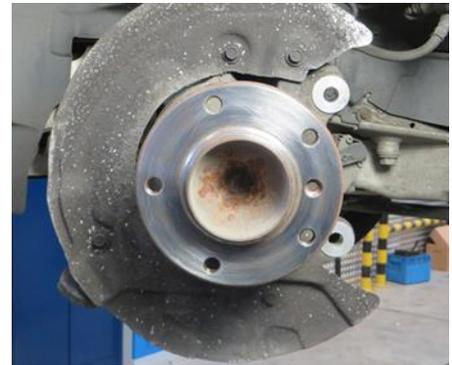
Montar o disco do travão e fixar com o parafuso de fixação.
