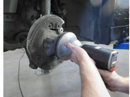
A superfície de encosto do cubo da roda não pode estar danificada, não pode ter ferrugem, tem que estar limpa e brilhante. Para prevenir a formação de corrosão deve-se pulverizar uma fina camada de óleo sobre a superfície de encosto e limpar com um pano que não desfibre.
