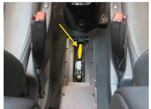
**Aviso:** o desbloqueio de emergência ou o elemento de comando do travão de imobilização elétrico é automaticamente reposicionado na posição de trabalho, assim que premir o botão EPB.
