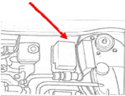
Se nestes veículos for reclamado o defeito supracitado, uma possível causa é a infiltração de água no ponto de barramento das fichas das cablagens, junto da parede cortafogo (ver figura).
