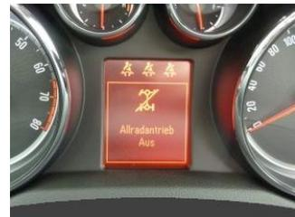
1. Como função de proteção após uma elevada rotação das rodas no modo de tração às quatro rodas, pode ocorrer a desativação temporária do sistema. Um software demasiado sensível desliga a tração às quatro rodas.
