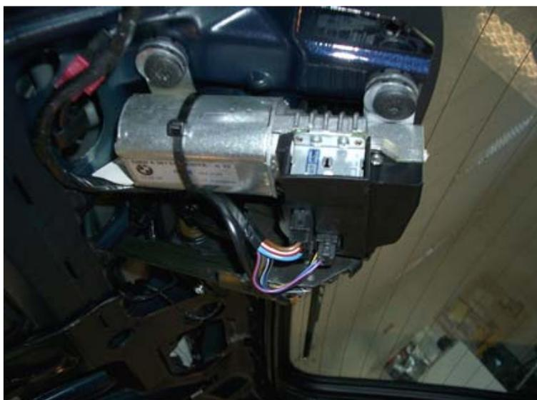
Motor do limpa vidros traseiro com módulo
