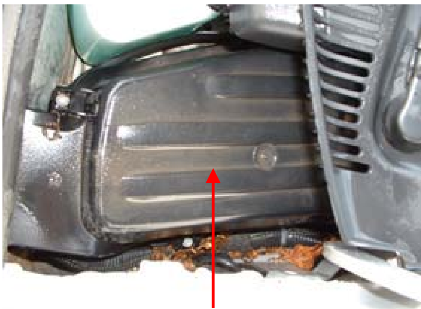
pokrywa skrzynki przekładników
