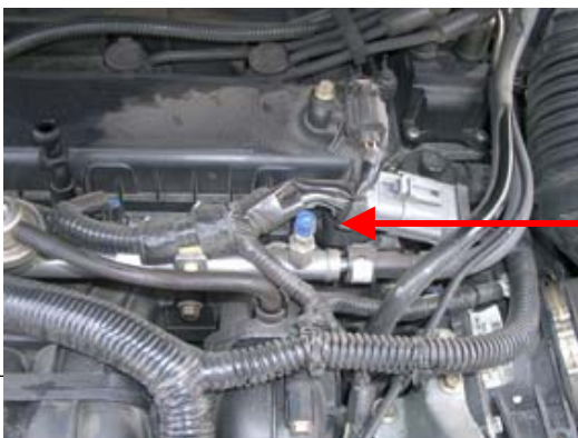
Testaansluiting voor de brandstofdruk
