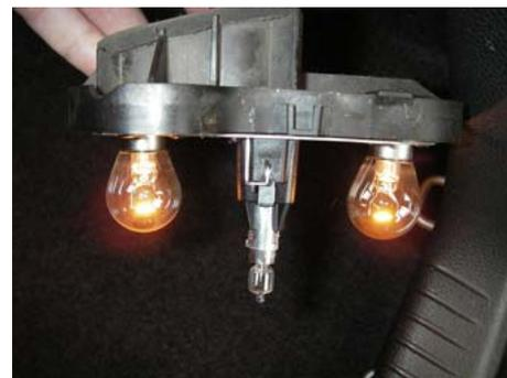
La causa di questo problema è che, all'inserimento dell'accensione, il veicolo esegue un "test a freddo". Durante questo test della resistenza ohmica delle lampadine si verifica la funzionalità dell'impianto di illuminazione.
