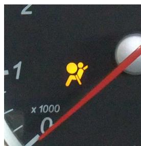
Si le témoin d'alerte du SRS s'allume sur les véhicules cités ci-dessus (figure) pendant un trajet, ceci peut être dû à un mauvais ajustement de l'interrupteur de la pédale de frein.
