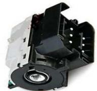
Afin de remédier à ce problème, il est nécessaire de remplacer l'interrupteur d'allumage (III.).
