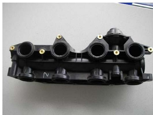
Module de clapets (démonté)
