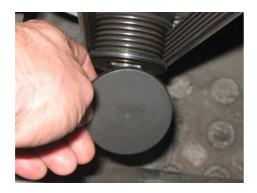
Sur les véhicules mentionnés ci-dessus, il est possible qu'une roue libre d'alternateur défectueuse cause une défaillance prématurée de l'alternateur.
