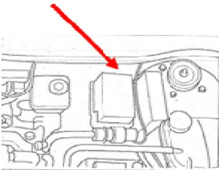
Si en estos vehículos se detectan los fallos arriba mencionados, puede deberse a un problema de entrada de agua en el empalme del enchufe del mazo de cables, cerca del salpicadero (ver imagen).
