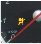
Si en los vehículos arriba mencionados se enciende durante la conducción el testigo luminoso de aviso de fallo en el sistema del Airbag (ver imagen), puede ser debido a que el interruptor del pedal del freno no esté bien ajustado.
