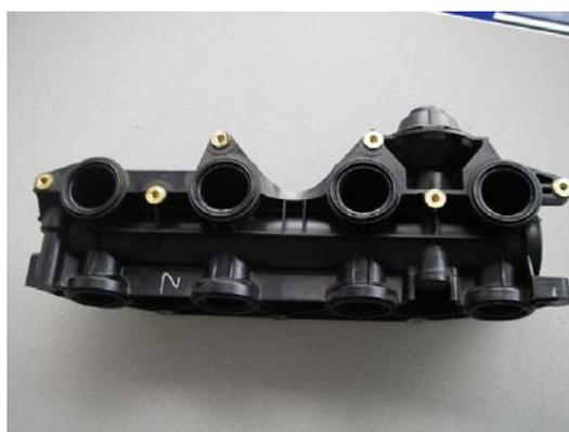
Módulo de válvulas (desmontado)
