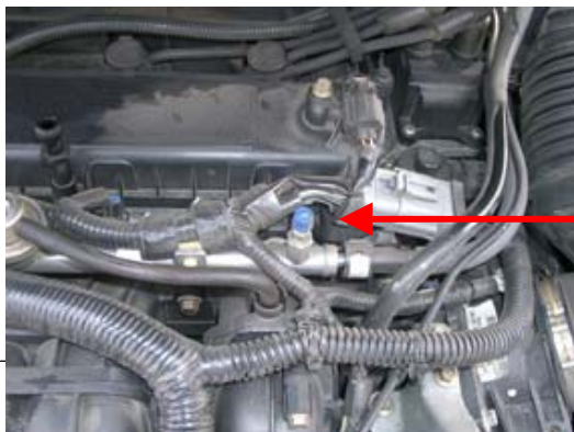
Conexión de control de la presión del combustible
