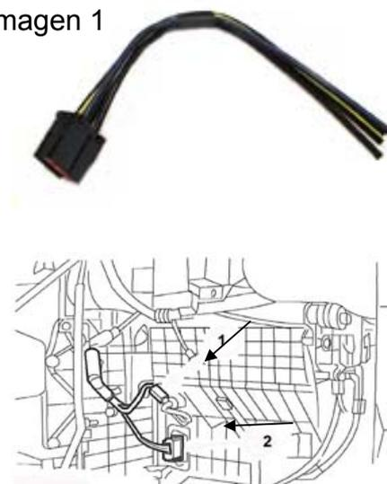
1. Conector del motor del ventilador
