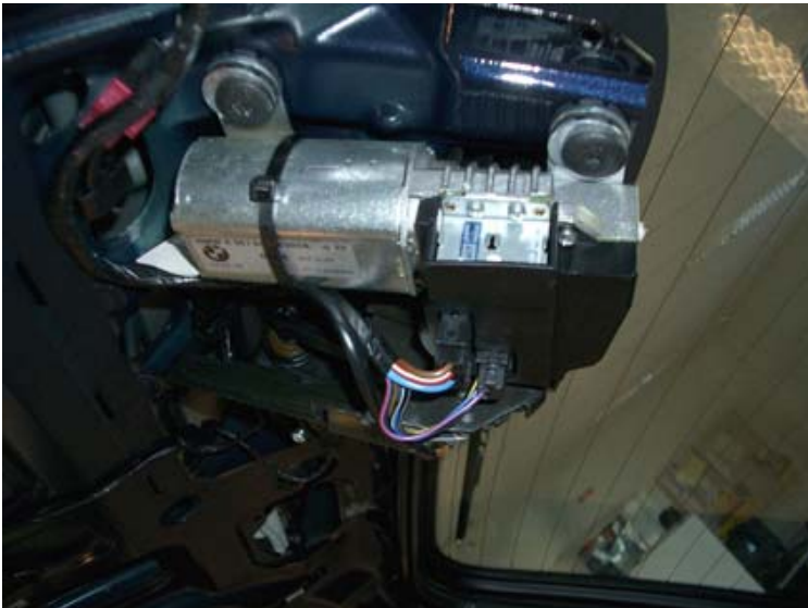
Motor til bagrudevisker med modul
