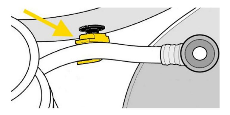
Unzureichende Befestigung der Unterdruckleitung des Bremskraftverstärkers, aufgrund einer fehlerhaften Halteklammer.
