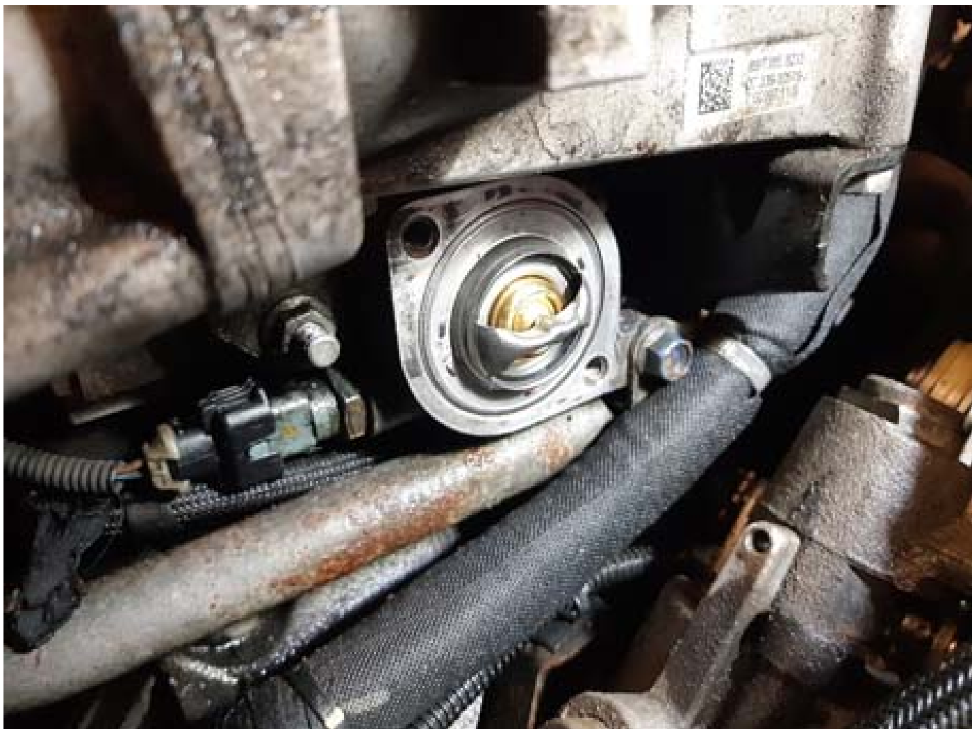
<p>Bild 2: Das Thermostat ist sichtbar und kann erneuert werden</p>
