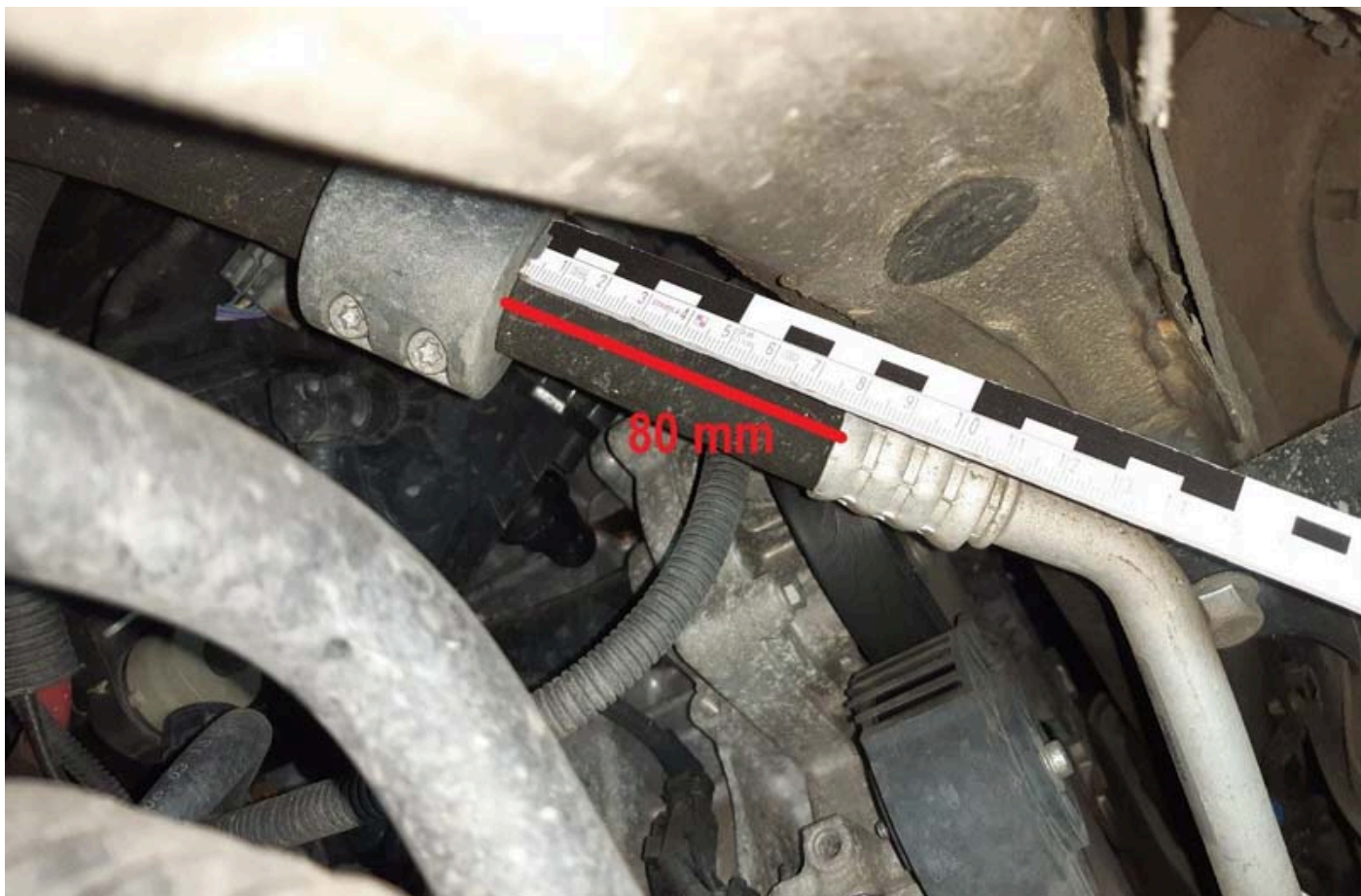
<p>Bild 1: Schwingungsdämpfer zur nachträglichen Montage</p>
