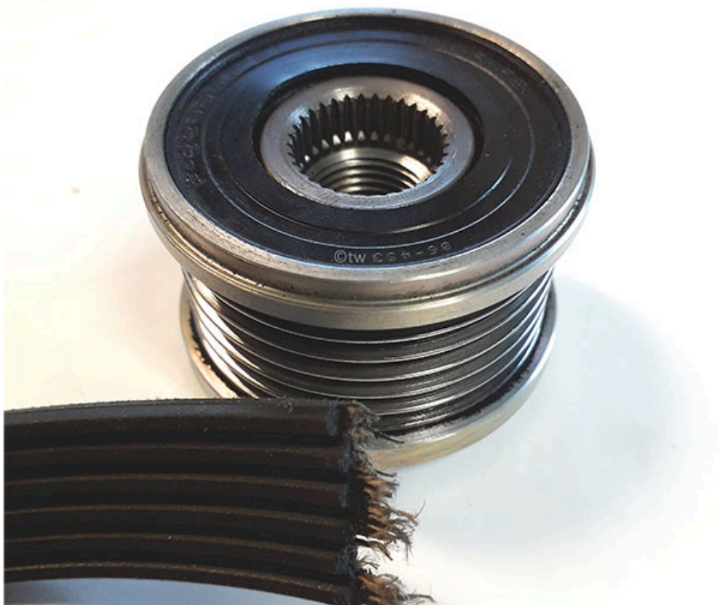
<p>Defekte Freilaufriemenscheibe mit gerissenem Keilrippenriemen</p>
