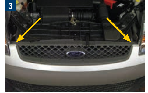
3 Park ve sinyal lambası (Sürücü tarafı / Yolcu tarafı)
