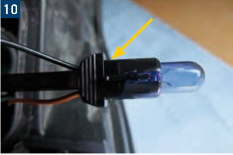
Pozisyon lambası (Sürücü tarafı / Yolcu tarafı)
