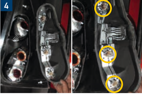
Pozisyon, fren, sinyal, sis ve geri vites lambası (Arka lamba)
