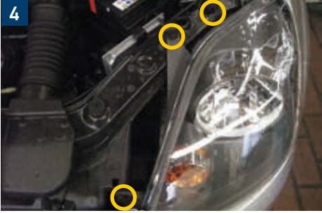
4 Park ve sinyal lambası (Sürücü tarafı / Yolcu tarafı)
