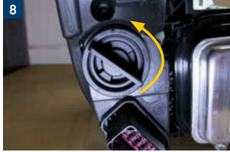
8 Sinyal lambası (Sürücü tarafı / Yolcu tarafı)
