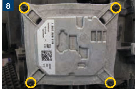
8 Sinyal lambası (Sürücü tarafı / Yolcu tarafı)
