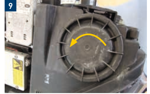
9 Viraj aydınlatma ve pozisyon lambası (Sürücü tarafı / Yolcu tarafı)
