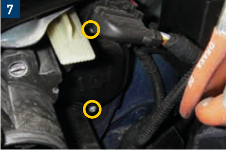
7 Uzun far ve statik viraj aydınlatması (Sürücü tarafı)
