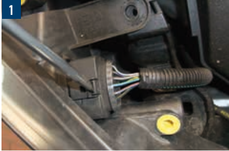
1 Kısa far, uzun far, pozisyon lambası ve sinyal lambası (Sürücü tarafı / Yolcu tarafı)
