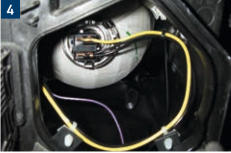
Kısa far, uzun far ve pozisyon lambası (Sürücü tarafı)
