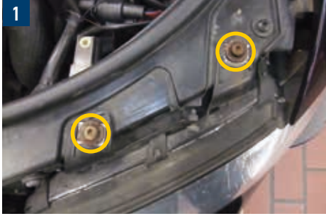
1 Pozisyon lambası ve uzun far (Sürücü tarafı)
