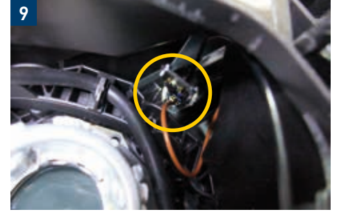
9 Pozisyon lambası (Sürücü tarafı / Yolcu tarafı)
