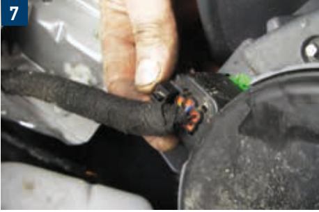
7 Park ve sinyal lambası (Sürücü tarafı / Yolcu tarafı)
