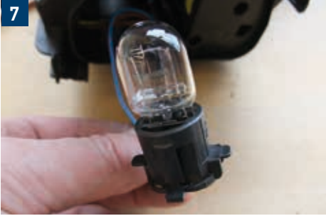
7 Pozisyon lambası / Gündüz sürüş farı (Sürücü tarafı / Yolcu tarafı)
