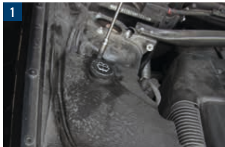
1 Luz de médios, luz máximos e luz de presença (Lado do acompanhante)
