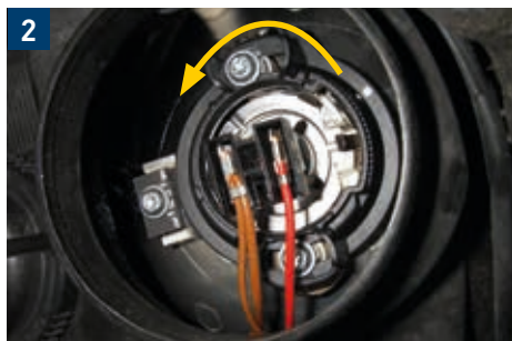
2 → Zdjąć gumową zaślepkę (światła mijania) z obudowy reflektora. → Odłączyć wtyczkę od żarówki i obrócić pierścień mocujący w lewo. → Wyciągnąć żarówkę z odbłyśnika i wymienić ją.
