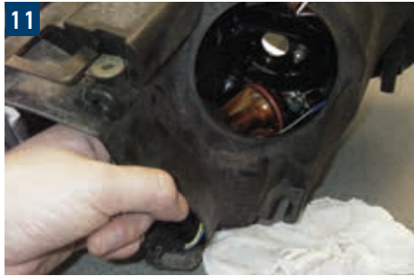
11 → De reflector door de grote opening iets naar achteren trekken en vervolgens naar boven uit de ronde opening verwijderen.
