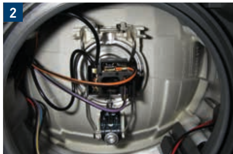
2 → Veerbeugel losmaken en de H4-gloeilamp vervangen.
