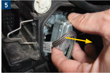
5 Ontstekingsmodule met xenonlamp (één eenheid) voorzichtig naar achteren uit de reflector trekken.
