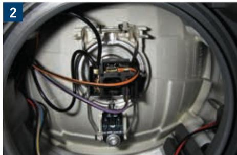
2 Allentare il morsetto metallico e sostituire la lampadina a incandescenza H4.
