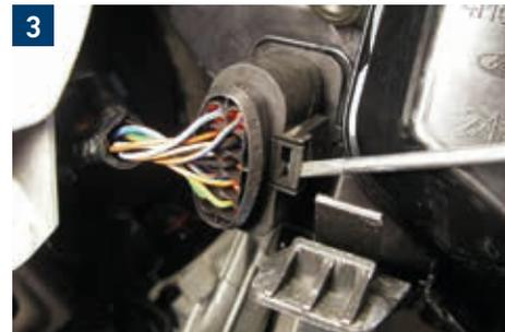
→ Svitare la vite di fissaggio (Torx 30) dal proiettore.
