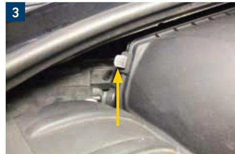
→ Svitare le viti di fissaggio del condotto di aspirazione.
