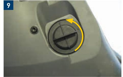
→ Ruotare verso sinistra l'attacco a impugnatura della lampada dell'indicatore di direzione fino all'arresto e rimuoverlo con la lampadina a incandescenza dal proiettore.
