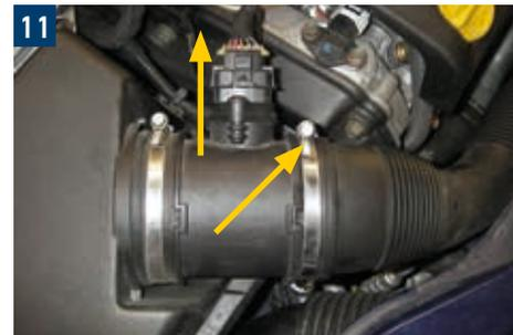
→ Staccare il connettore dal debimetro, allentare la fascetta stringitubo esterna e staccare il tubo dell'aria di aspirazione.
