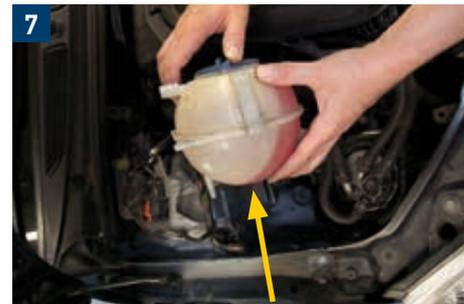
→ Smontare il perno filettato dal serbatoio del refrigerante (2 x 10 mm) [Fig. 6] e metterlo da parte.
