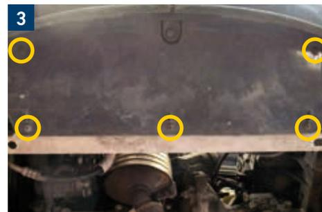
→ Smontare il paraurti. A tal scopo, svitare le quattro viti (8 mm) nella parte superiore del supporto della serratura.
