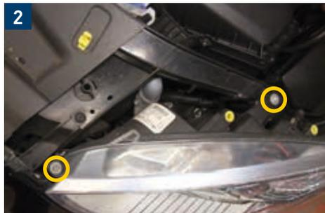
→ Svitare le viti di fissaggio (2 x Torx 30).
