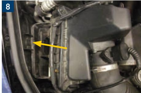
→ Smontare la scatola del filtro dell'aria. A tal scopo, smontare il tappo di fissaggio.
