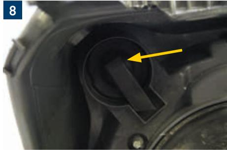
→ Rimuovere la calotta in gomma dalla luce di posizione, estrarre il portalampada con la lampada dal riflettore e sostituire la lampadina a incandescenza.
