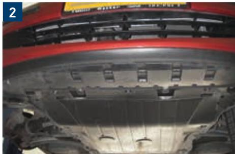
→ Smontare il rivestimento del sottoscocca (10 SW).
