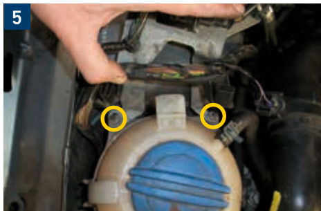
5 Feux de position (Côté passager)
