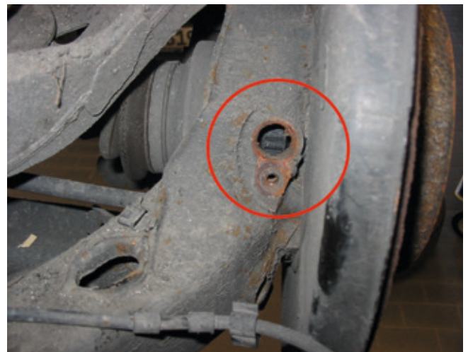
Sprawdzić mocowanie czujnika i pierścień impulsowy
