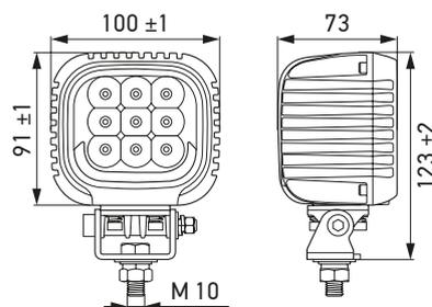
Per l'uso nel traffico su strada, il faro da lavoro deve essere montato con luce di posizione bianca senza inclinazione (0°).
