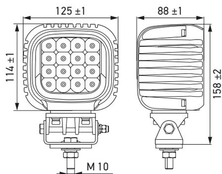
Per l'uso nel traffico su strada, il faro da lavoro deve essere montato con luce di posizione bianca senza inclinazione (0°).
