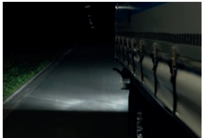
Ausleuchtung mit zusätzlichen Rückfahrscheinwerfern
